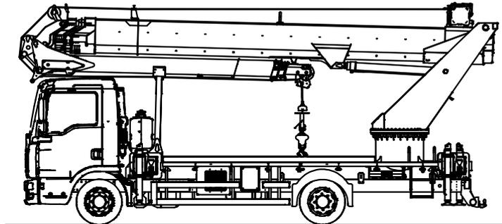
Der Böcker Autokran AK 37/4000 wird auf einem 7,49t LKW aufgebaut.
